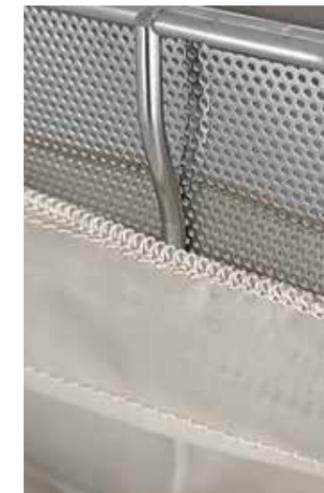
Tramite una pompa di carico, poi, l'olio viene riportato in vasca. Questo processo consente di mantenere l'olio ad un'alta temperatura e risparmiare energia nel riportarlo alla temperatura di esercizio. Allunga la vita dell'olio, mantenendolo sempre pulito e libero da impurità, ottimizza consumi e tempo.
